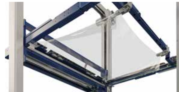
TOP (OPT.) Mettifoglio automatico per protezione del prodotto dall'acqua. Automatic top sheet insertion for product water protection.
